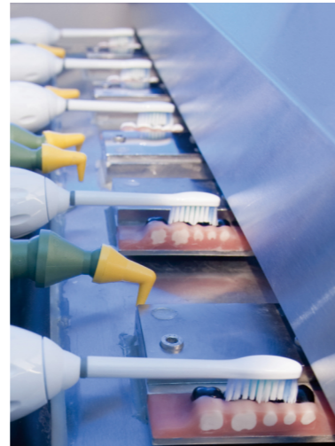
Zahnbürsten - für den Test in eine Putzmaschine eingespannt.
